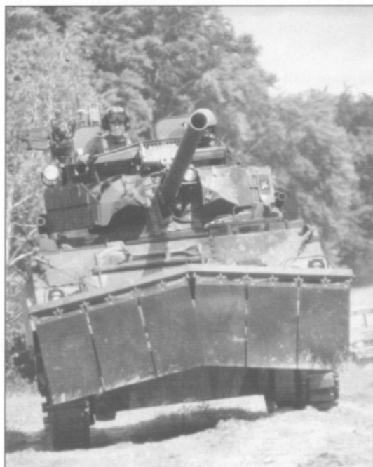
◀ de opvouwbare rubber lappen aan de voorkant simuleren de KMT-6 antimijnploeg
